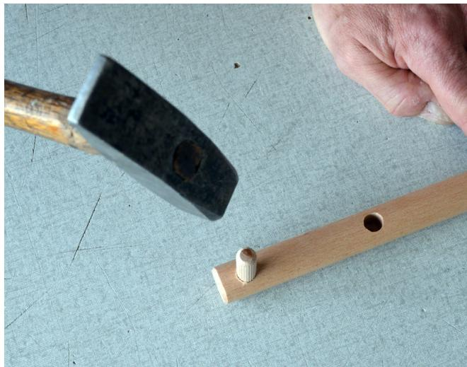
Zu Beginn müssen die zwei 10-mm-Dübel in die dafür vorgesehenen Löcher des 20 mm Dübels eingeschlagen werden. Sie entscheiden in welches Loch, dies kommt auf die Dicke ihrer Zielscheibe an.
